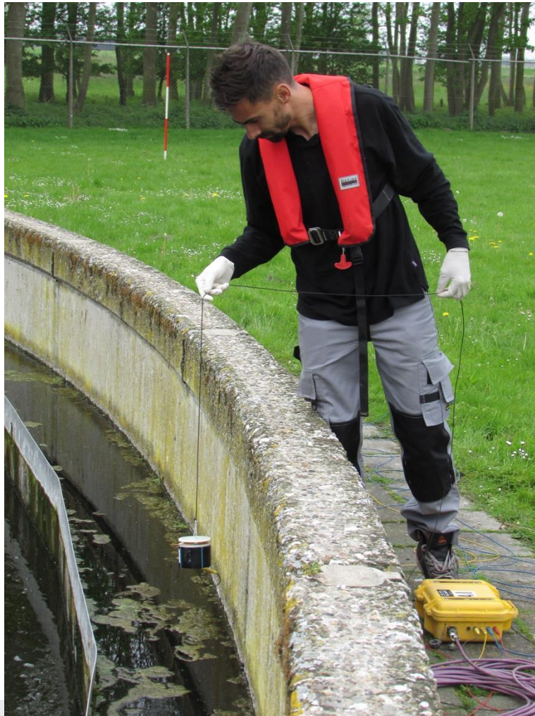
Foto: Aanbrengen meetelektrode.
